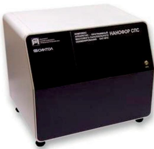
Рис. 9. Полногеномный секвенатор ДНК НАНОФОР СПС
