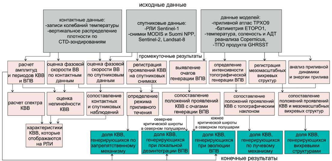
Рис. 10. Блок-схема метода количественной оценки вклада различных механизмов в генерацию КВВ
