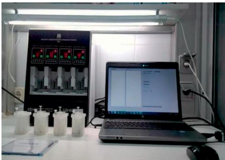
Рис. 7. Комплекс КВНК для выделения нуклеиновых кислот
